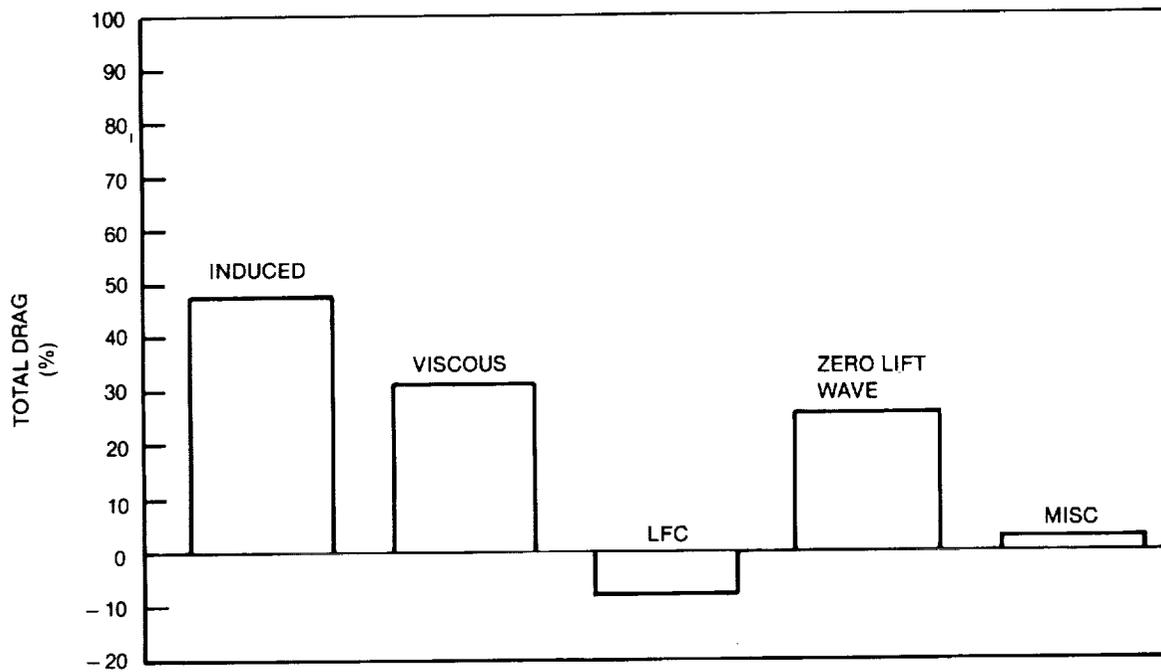
**FIGURE 2-29. DRAG BREAKDOWN — D3.2-4B CONCEPT**
