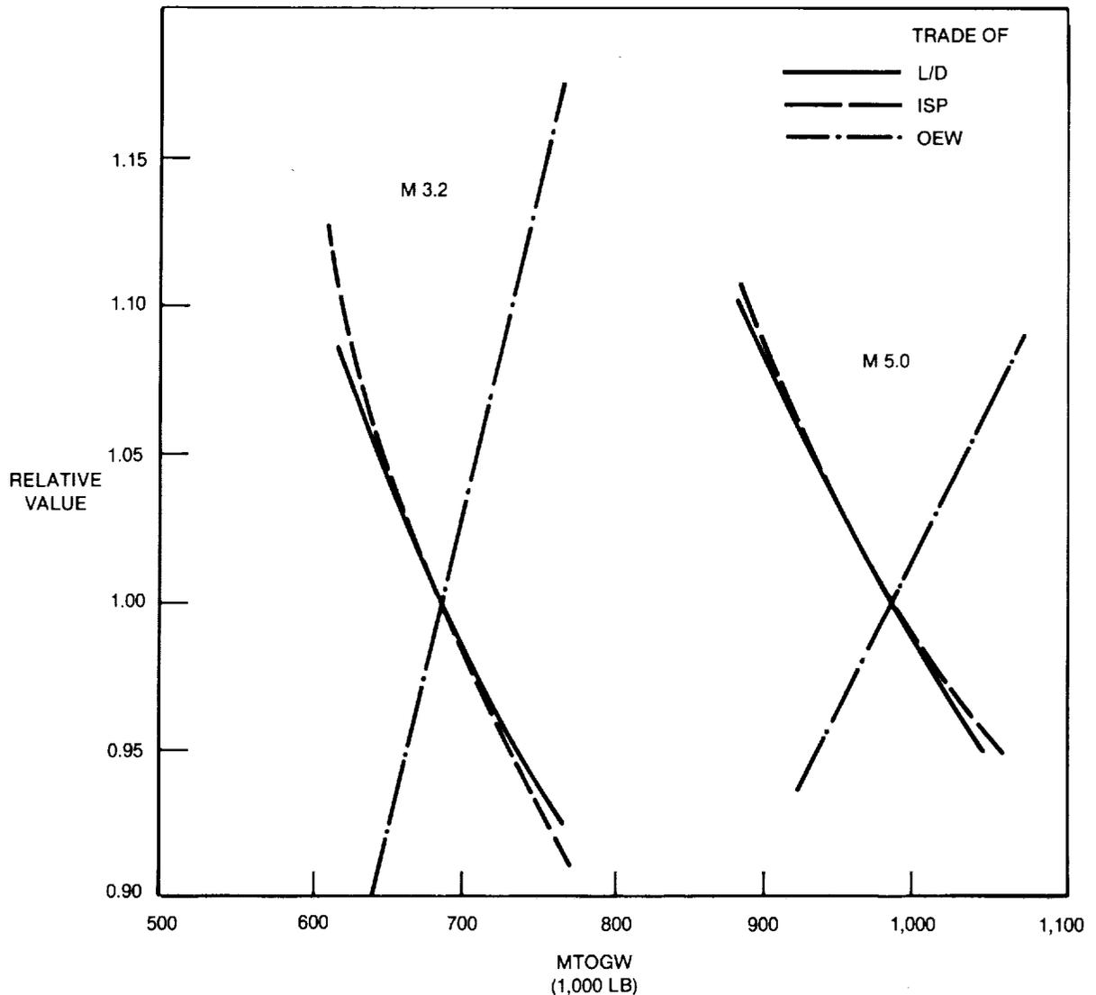
**FIGURE 3-15. SENSITIVITY OF MAXIMUM TAKEOFF GROSS WEIGHT**
