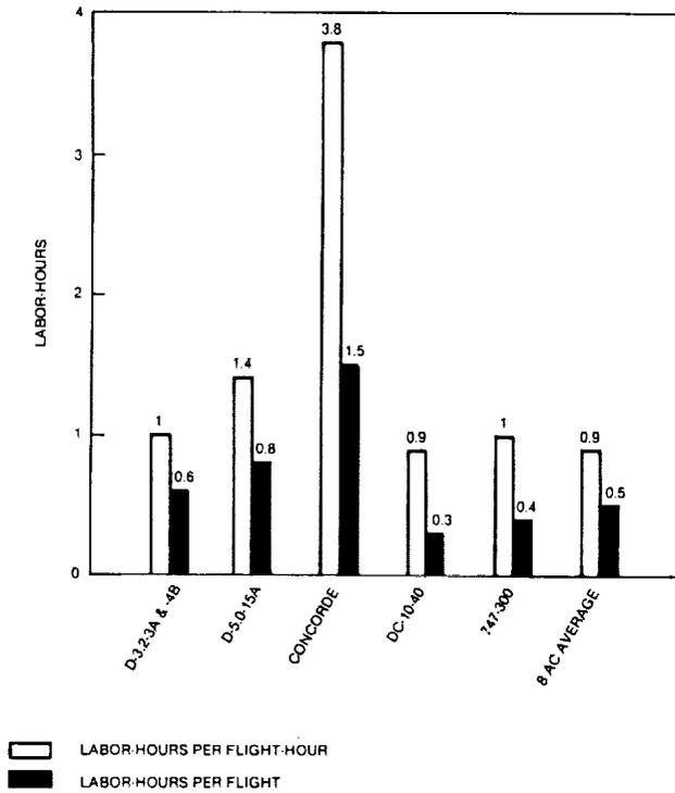
**FIGURE 3-18. ENGINE MAINTENANCE LABOR-HOURS BASELINE VALUES**
