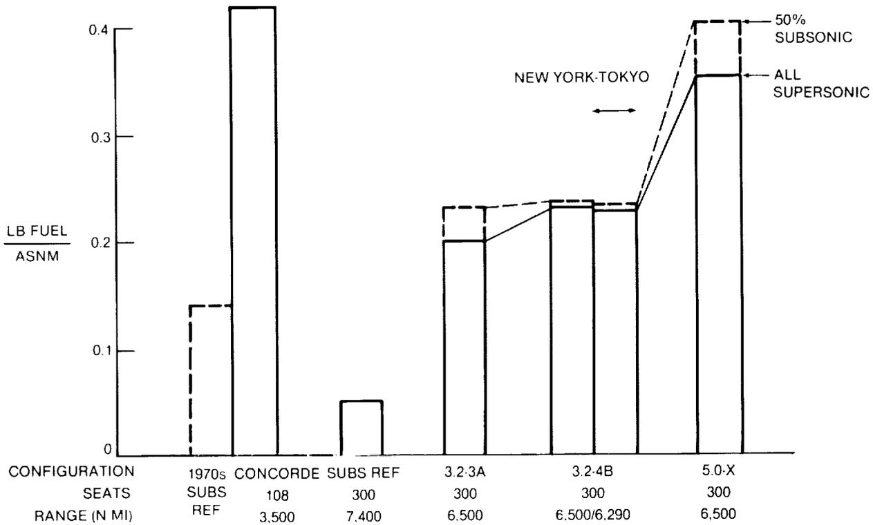
FIGURE 3-14. FUEL EFFICIENCY
