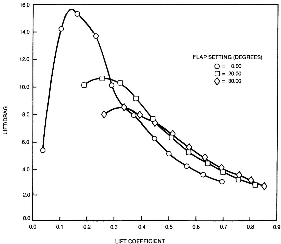
**FIGURE 2-27. TRIMMED LOW-SPEED LIFT/DRAGE — D3.2-4B CONCEPT LEADING EDGE SCHEDULE R**
