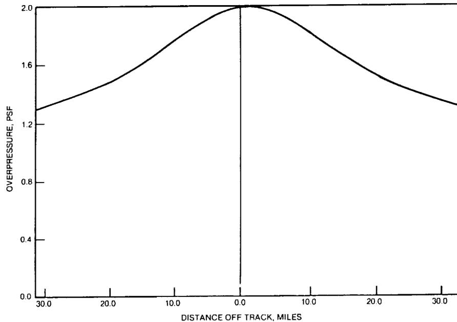
**FIGURE 4-6. SONIC BOOM OVERPRESSURES ON THE GROUND FOR MACH 5.0 CONCEPT**
