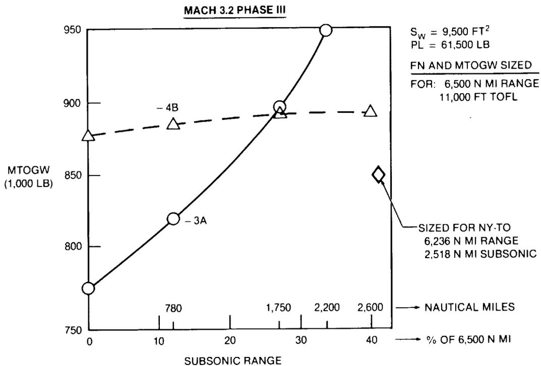
**FIGURE 3-7. SIZINGS FOR PARTIALLY SUBSONIC RANGE**
