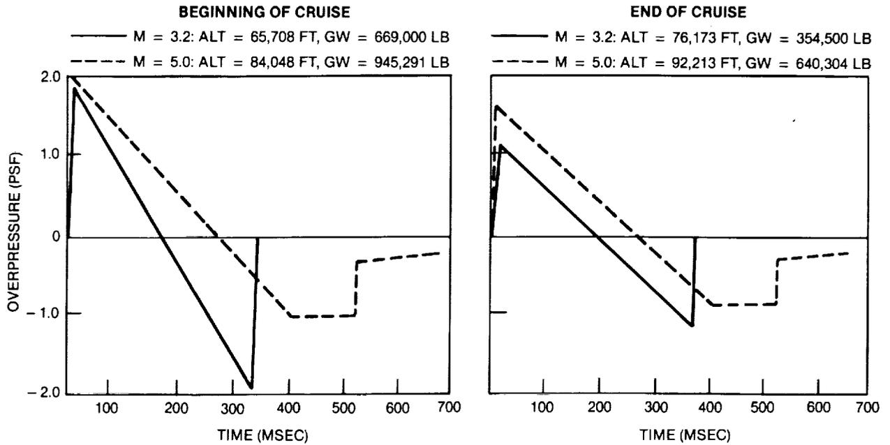
**FIGURE 4-4. SONIC BOOM WAVEFORMS**
