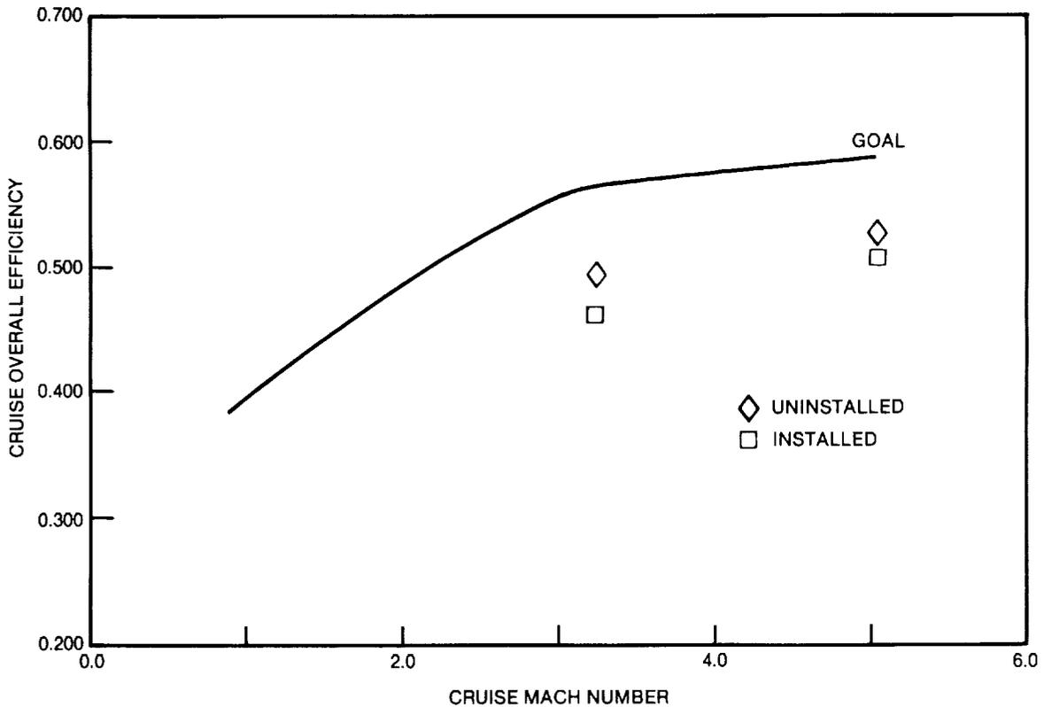
**FIGURE 2-35. PEAK CRUISE OVERALL EFFICIENCY — PHASE III BASELINE ENGINES**
