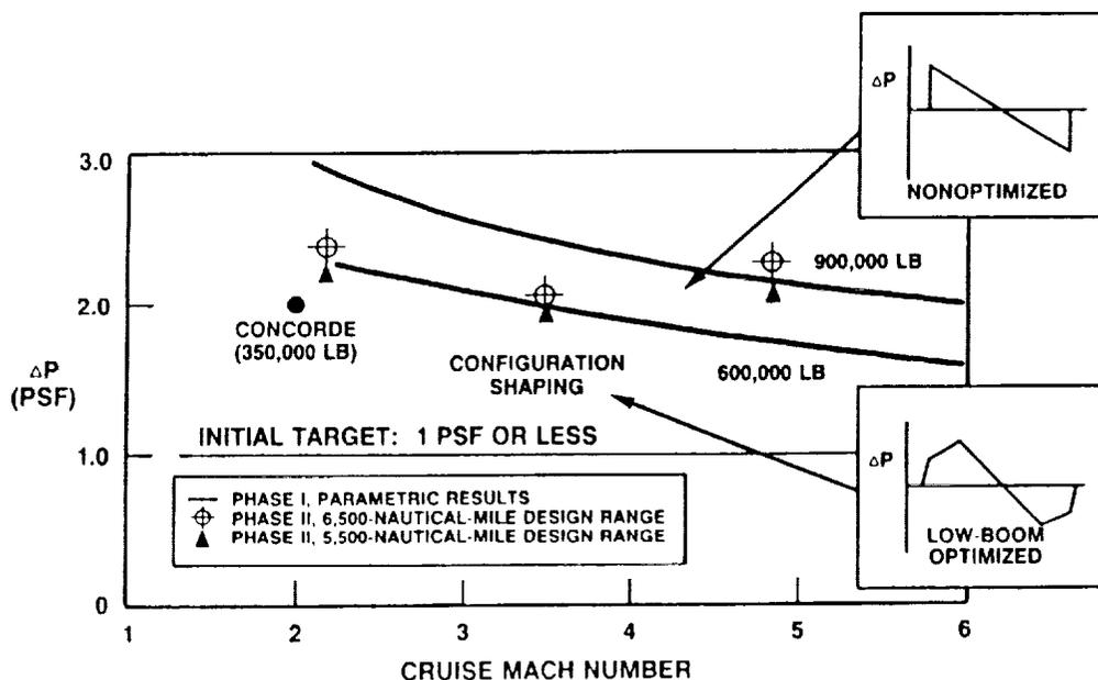
FIGURE 1-15. PHASE II SONIC BOOM GROUND LEVEL OVERPRESSURE
