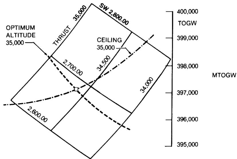
FIGURE 3-4. SIZING FOR SUBSONIC AIRPLANE
