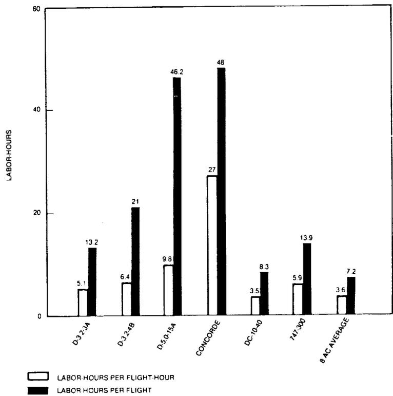
**FIGURE 3-16. AIRFRAME MAINTENANCE LABOR-HOURS BASELINE VALUES**
