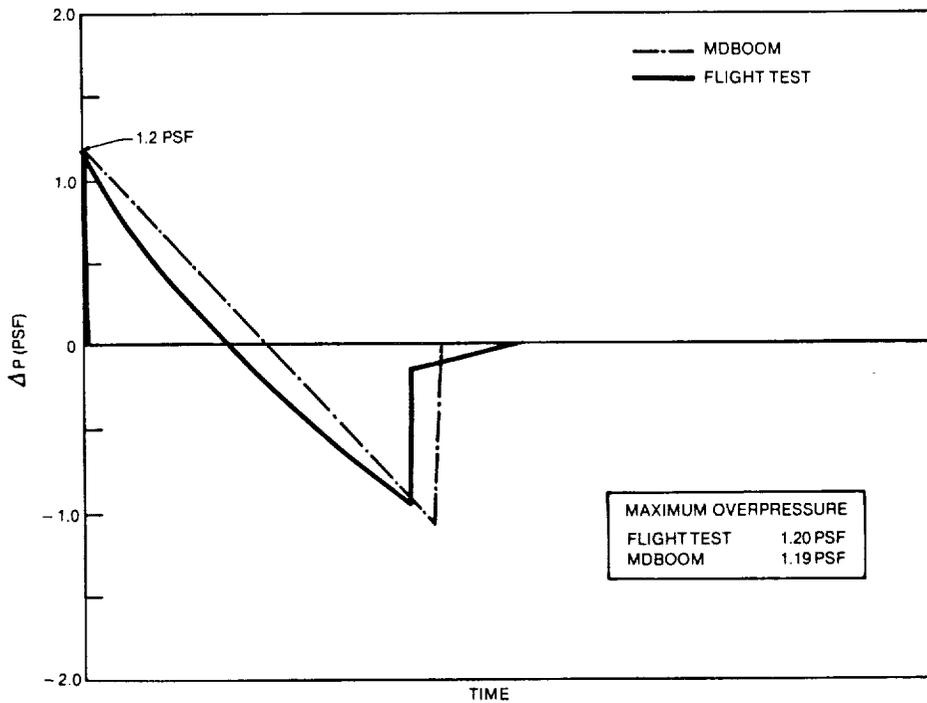
**FIGURE 4-3. FLIGHT TEST DATA OF SR-71 SONIC BOOM VERSUS PREDICTION FROM MDBOOM**
