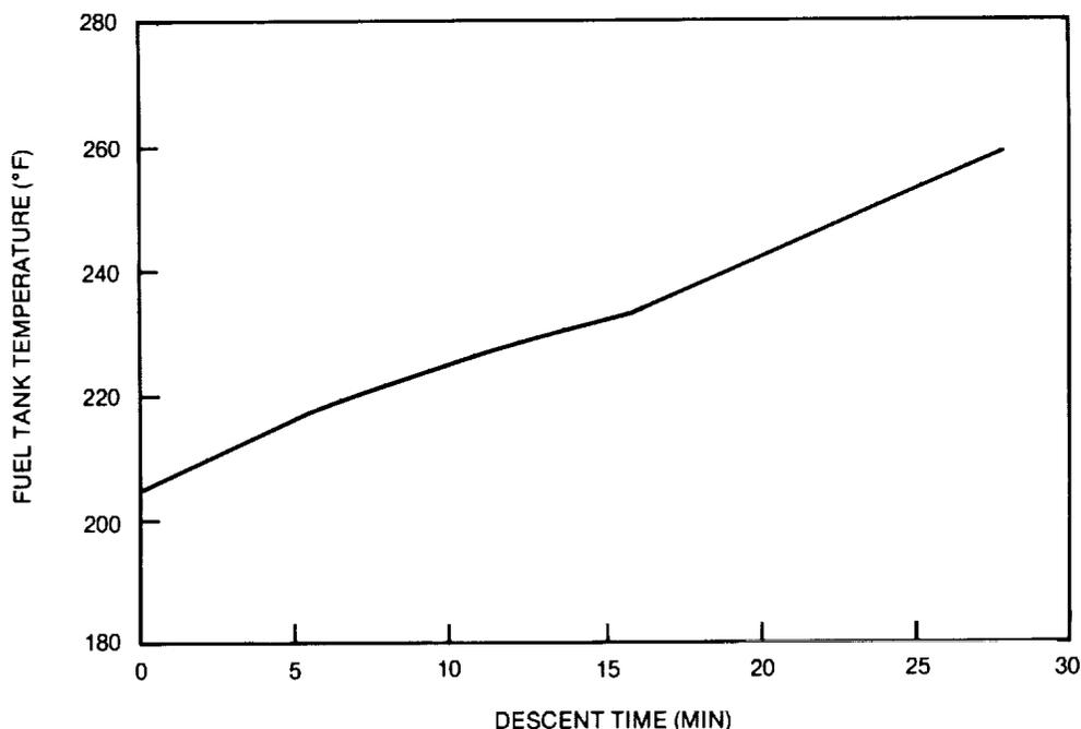
**FIGURE 2-66. MACH 3.2 FUEL TANK TEMPERATURE ON DESCENT**
