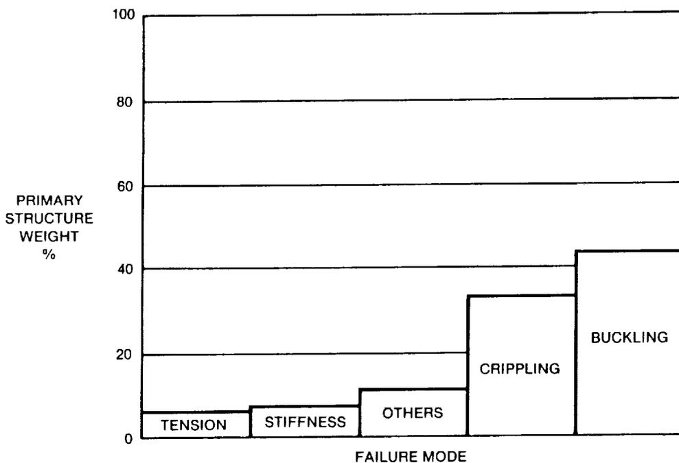
**FIGURE 2-71. FAILURE MODE WEIGHT DISTRIBUTION**
