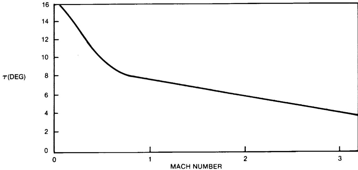
**FIGURE 2-16. TURBULENCE SPREAD ANGLE**
