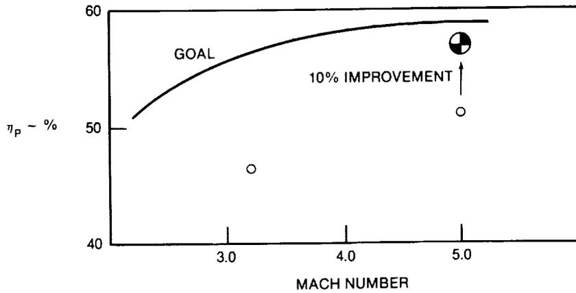
FIGURE 3-9. OVERALL PROPULSIVE EFFICIENCY IN CRUISE
