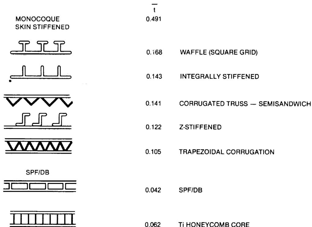
FIGURE 2-74. PARAMETRIC TRADES — FUSELAGE MIDBODY
