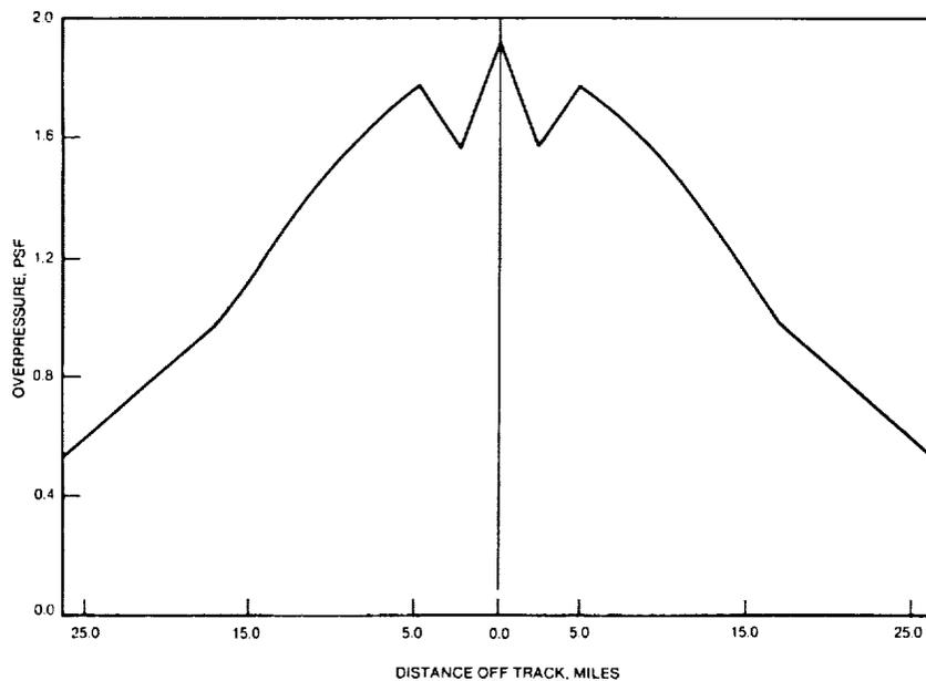
**FIGURE 4-5. SONIC BOOM OVERPRESSURES ON THE GROUND FOR MACH 3.2 CONCEPT**
