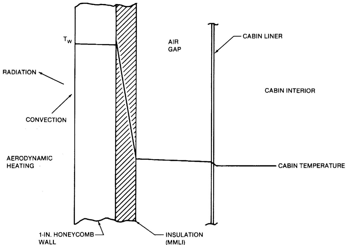
**FIGURE 2-59. MACH 3.2 FUSELAGE INSULATION DESIGN**
