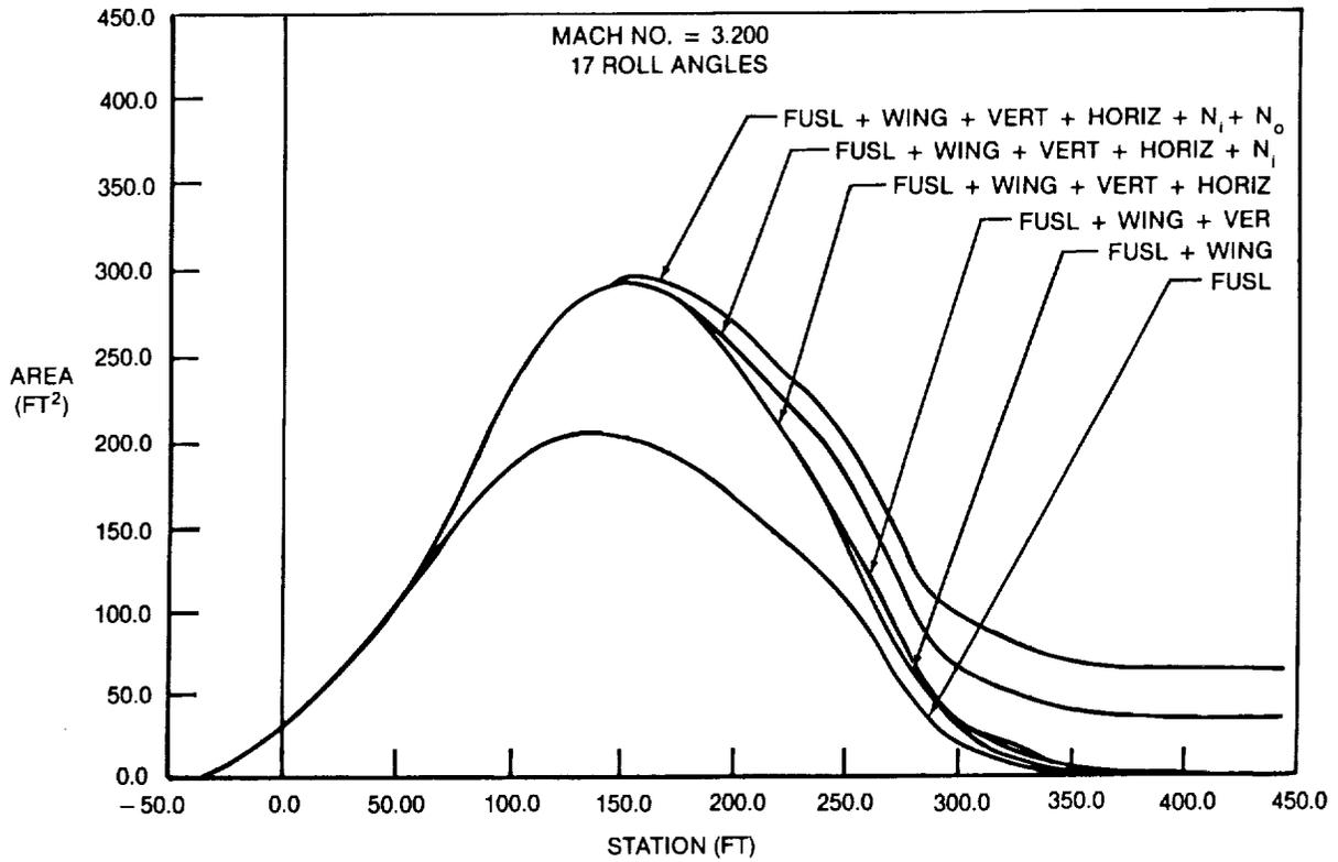
FIGURE 2-11. D3.2-3A AREA DISTRIBUTION AT MACH 3.2
