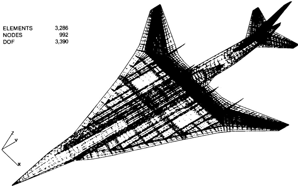
**FIGURE 2-72. FINITE ELEMENT MODEL — MACH 3.2 CONCEPT**
