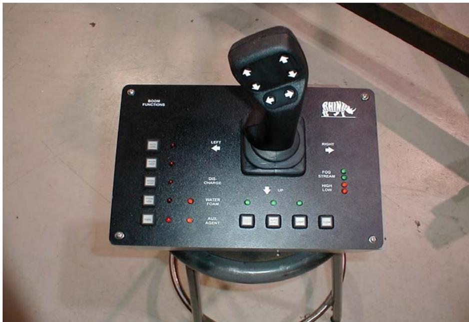
FIGURE 10. THE HIGH-PERFORMANCE, MULTIPOSITION, BUMPER-MOUNTED TURRET NOZZLE JOYSTICK CONTROL
